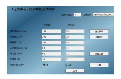
匹配高低档次的设备,结合具体的生产条件(比如来料等),自动选取工艺和设备的最优参数组合
